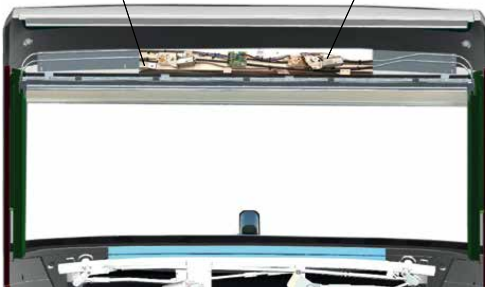
Bild över motor med nödmanövrering och kretskort, höger sida
