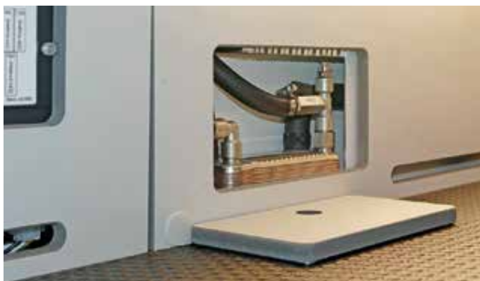
Värmeväxlare bakom dubbelgolv- lucka på förarsidan
