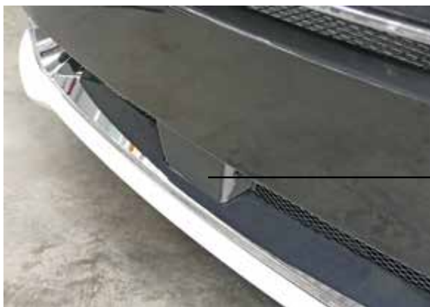
Skydd, radar för Ivecos förarassistenssystem
