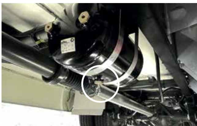
Trycklufttank, luftfjädrade fö- rarhyttstolar under chassit, förarsidan
