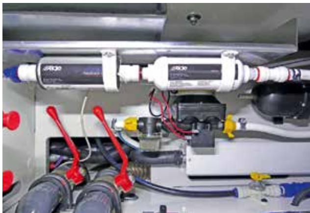
Vattenpump med vattenfilter och UV-kolfilter i anslutningsfacket (tillval)
