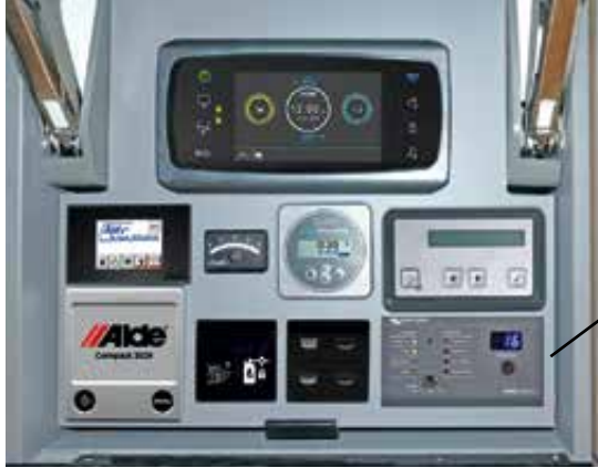
Manöverpanel (fjärrstyrning) laddare/växelriktare vid in- gången
