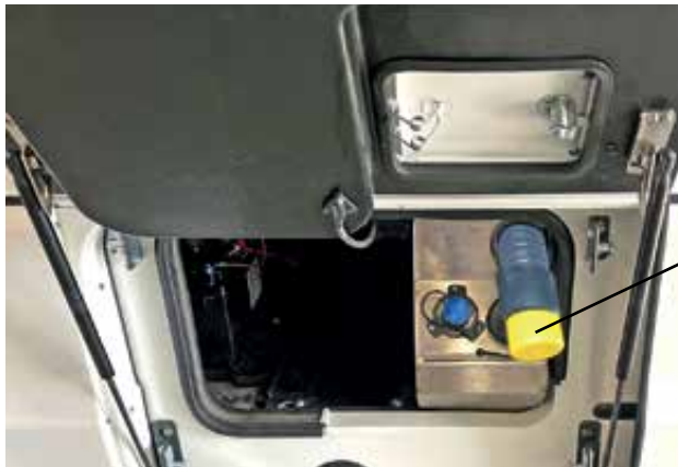
Tömnings slang (tillval) ovanför tankröret för diesel, förarsidan
