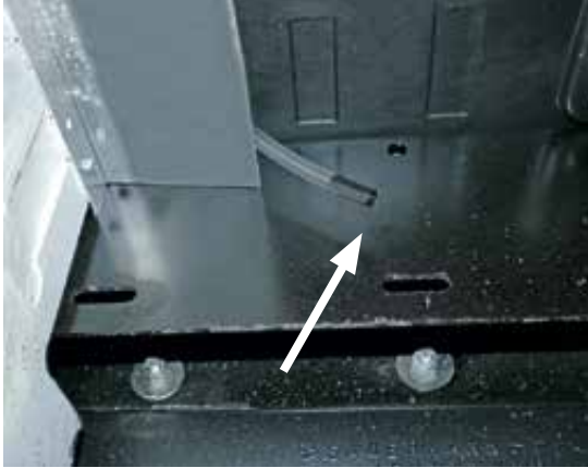
Utlöppsrör kondensvatten för förarhyttens klimatanläggning under chassit, förarsidan
