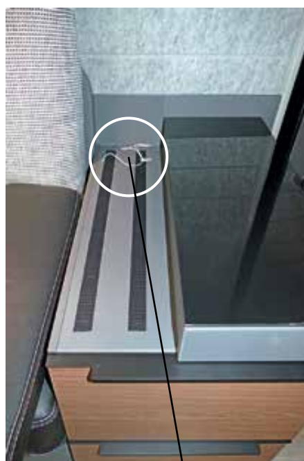
Nödlinan, upplåsning av länksystem för lådor på passagerarsidan
