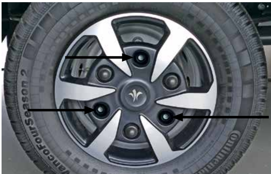
Placering av fästpunkter, aluminiumfälg sida - bakaxel
