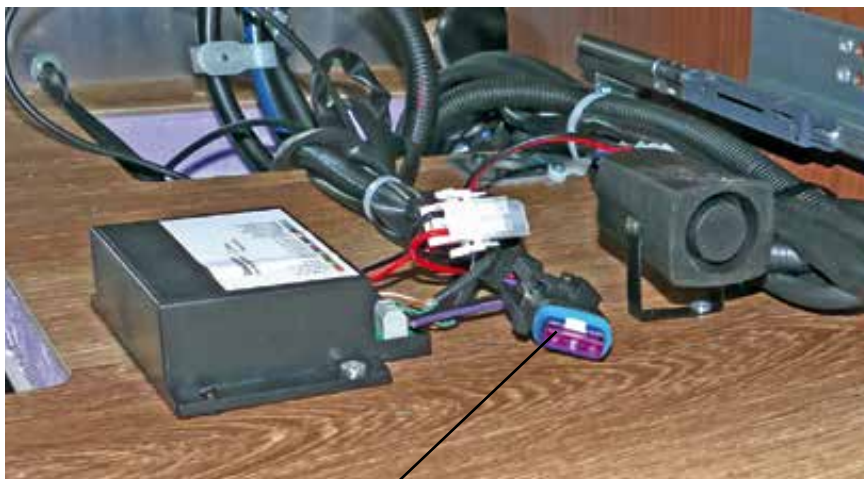
3 A-säkring för elektrisk matarledning till narkoslarmets komponenter
