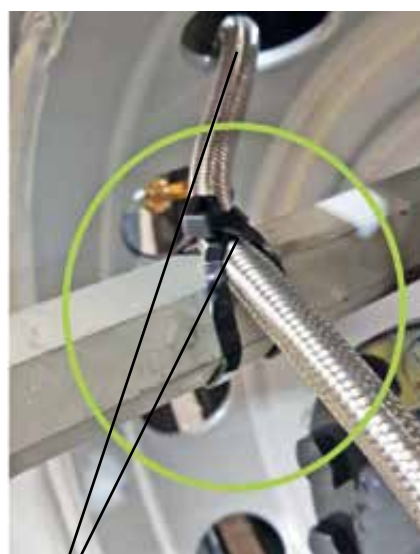
Ventiltörlängning som letts ut genom hålet i fälgen samt fästs med buntband i det långa hjulfästet
