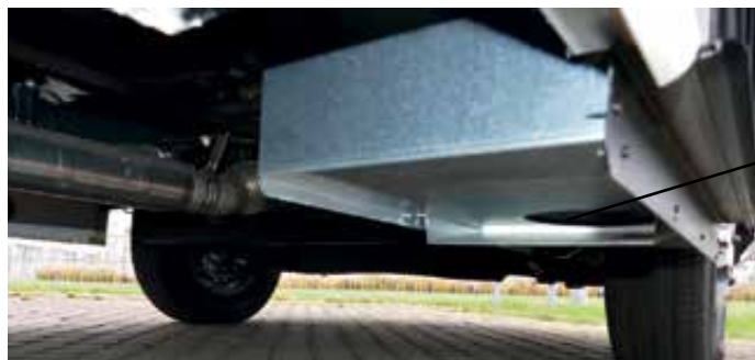
Tvångsventilation, gasolflaskutrymme under chassiet
