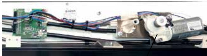
Bild över motor med nödmanövrering och kretskort, höger sida
