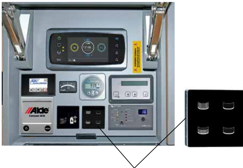
Knappmodul i väggskåpets panelfack (varierande placering beroende på utrustning)
