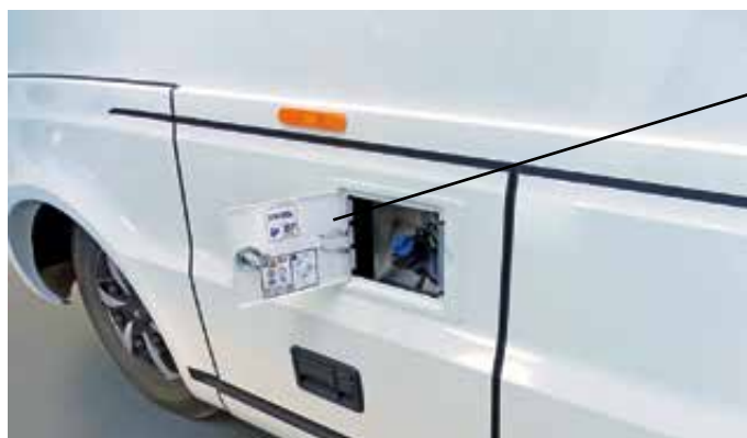
Lucka till AdBlue®- påfyllningsrör på förarsidan
