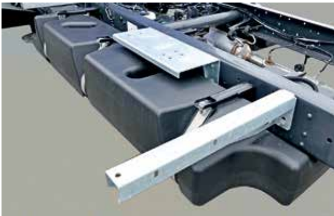
Dieseltank under chassit, förarsidan
