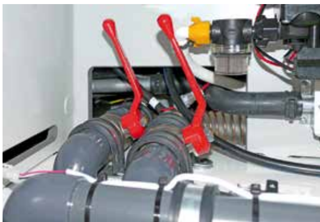
Tömningsventiler Tömning vatten- och avloppstank. Ventiler i anslutningsfacket (Bilden visar stängda ventiler)
