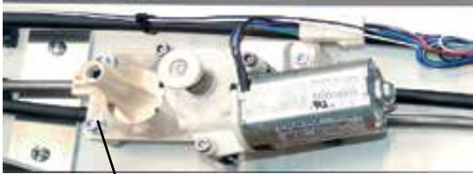
Bild över motor med nödmanövrering, vänster sida
