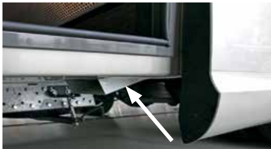
Tvångsventilation garage under garagegolvet, passagerarsidan
