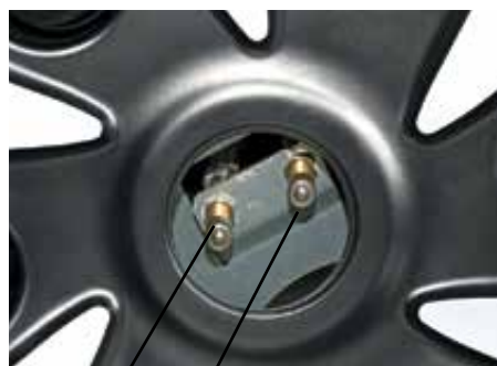
Ventilförlängning av metall på bakaxeln, i främre synliga delen (bilden visar tvillingdäck med fälgssida av aluminium)
