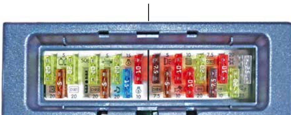
3 A Termisk säkring i reläboxen
