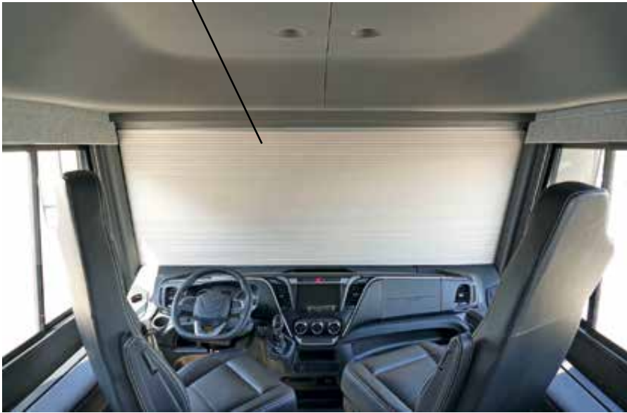
Manövrera frontplissén med manöverpanelen i förarhytten
