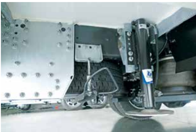
Reservhjul under chassit, frigö- ring på passagerar- sidan
