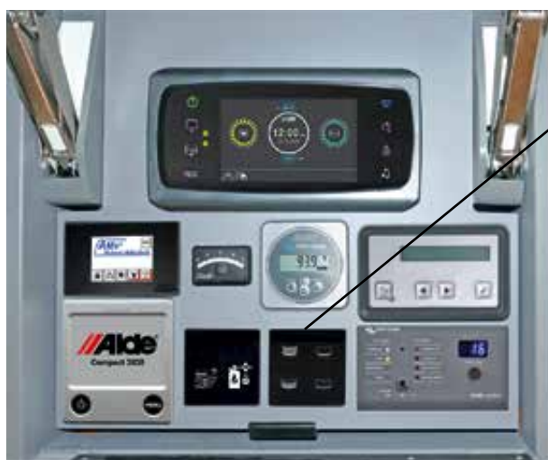
Etuverhon painike-moduuli yläkaapissa sisääntulon alueella
