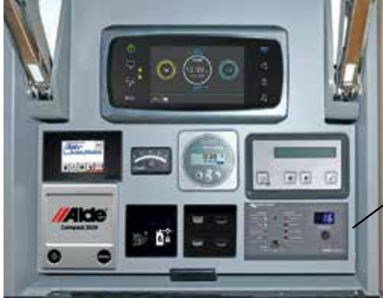
Laturin/invertterin käyttöpaneeli (kauko-ohjain) sisäänkäynnin kohdalla
