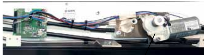
Kuvassa moottori ja hätäkäyttö sekä ohjauspiirilevy oikealla puolella
