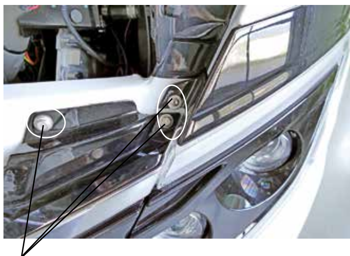
Ruuvit etuspoilerin kiinnitykselle
