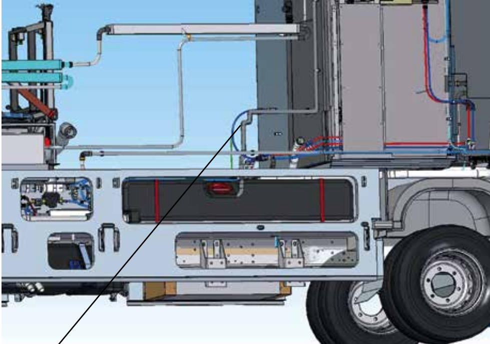
Ulostesäiliön tuuletus katolla
