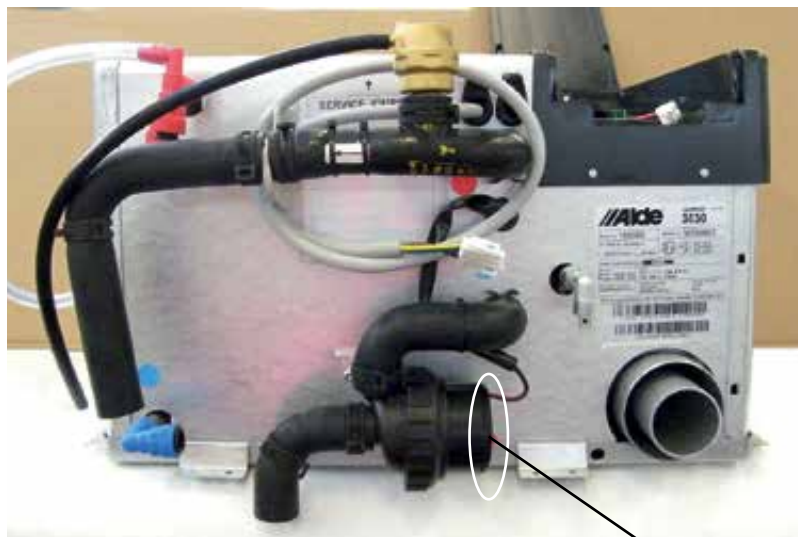
Pumpun säätö teho 2
