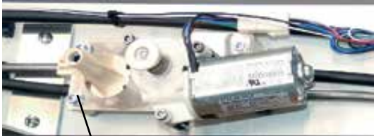
Kuvassa moottori ja hätäkäyttö vasemalla puolella
