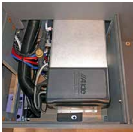
Värmepanna, vattenburen värme med varmvattenberedare (tillval) Åtkomst via soffbänk på förarsidan
