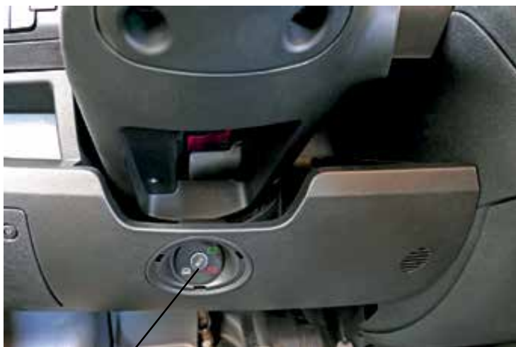
Frånskiljare fordonsbatteri under rattstäng
