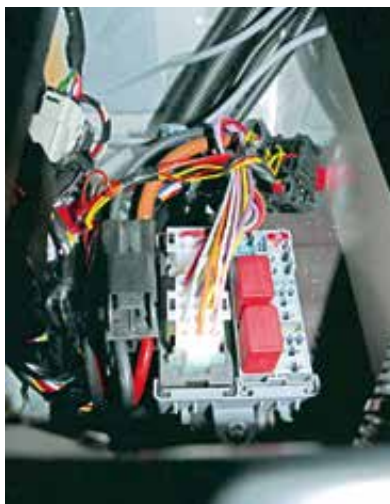
Extra säkringsplats för fordonets elsystem
