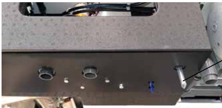
Slangstuts, säkerhets-/ avtappingsventil
