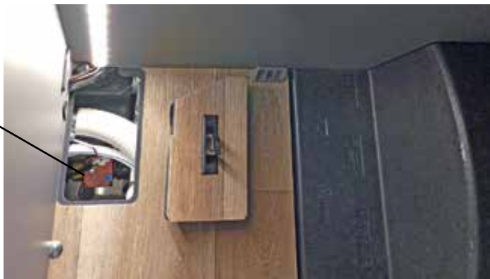
Tömningsventil latrintank under garderobsgolvet, modell 6.9E
