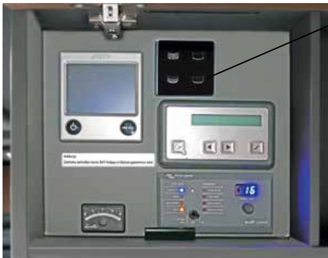
Knappmodul i väggskåpets panelfack
