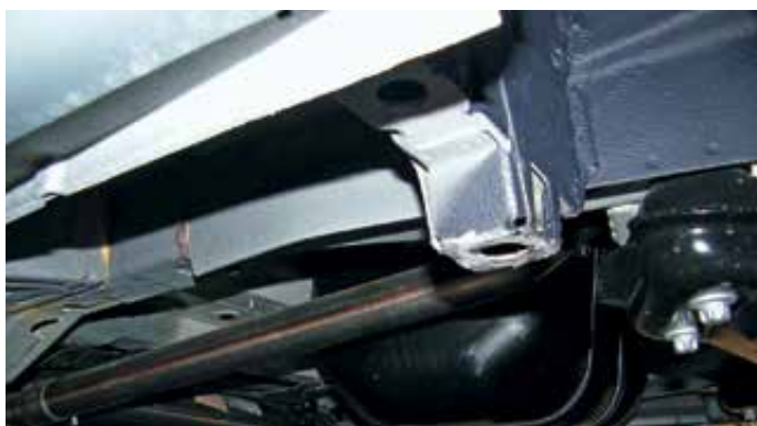
Lyftpunkt för domkraft vid framaxeln
