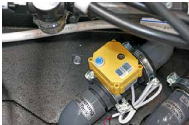
Tömningsventil elektrisk, avloppstank (extrautrustning) i anslutningsfacket
