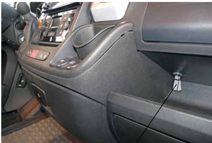
2 st USB-uttag, anslutning navigationsenhet
