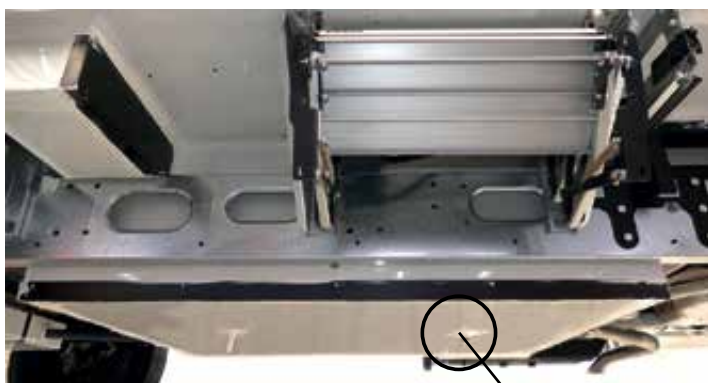
Spillrör och ventilation avloppstank Placering, mellangolv under tanktråg
