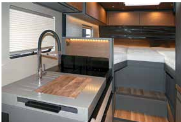
Bild före avfärden Kökslift i nedre position, skyddslock över gasolspis inskjutet, utdragsskiva i köket inskjuten, skärbräda på diskhon
