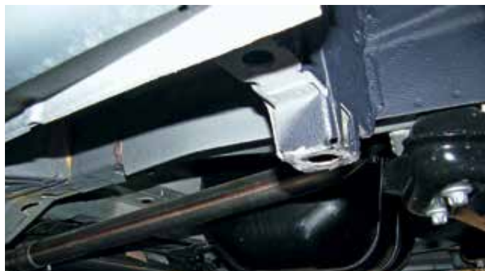
Lyftpunkt för domkraft vid framaxeln
