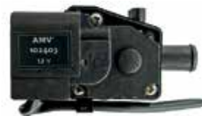
Elektronisk kylvätskeventil i motorrummet
