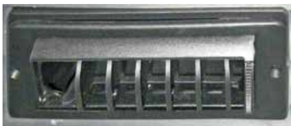
Varmluftöppningar, justerbart munstycke, avlångt fyrkantigt munstycke under förar- och passagerarstol
