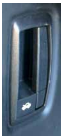
Spaka, frigöring motorhuv
