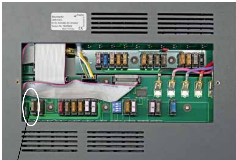
Lastmodulbox med öppen frontskiva (se kapitel Elsystem)
