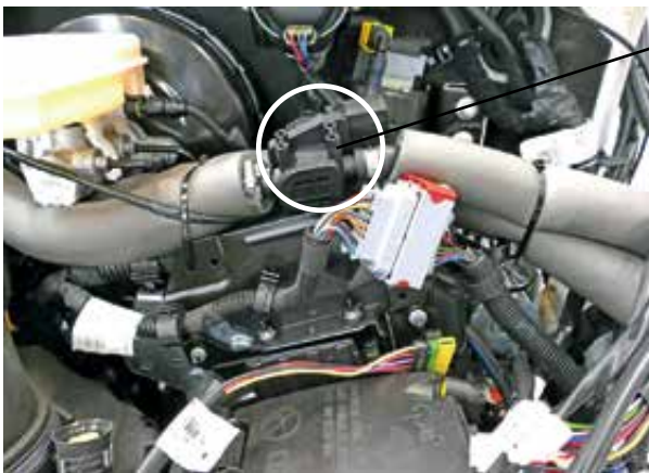
Relä och flatsäkring 2 A, elektrisk magnetventil
