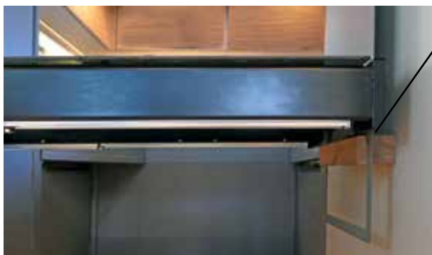
Utdragbart gasolspislock, säkrat på trälist
