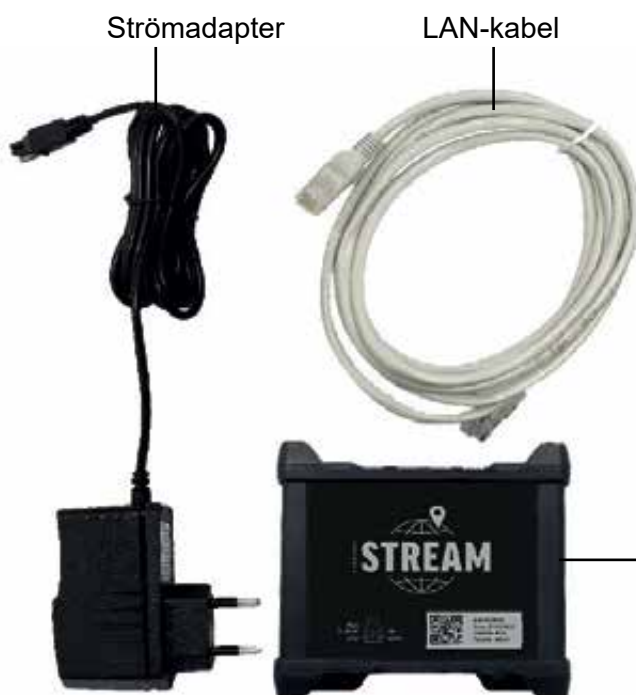
LTE/WIFI router "Stream" från Alphatronics
