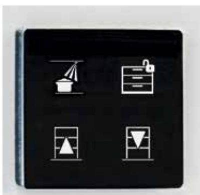
Nedre knappmodul på badrums- väggen
