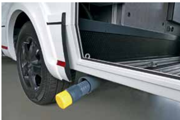
Tömningsventil elektrisk, latrintank (extrautrustning) i mellangolvet, i närheten av latrintanken (bilden visar 7.3F)
