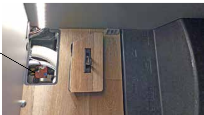
Tömningsventil latrintank under garderobsgolvet, modell 6.9E
