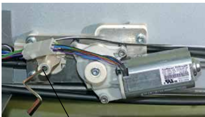
Nödvev, ingår i fordonets verktygsutrustning
