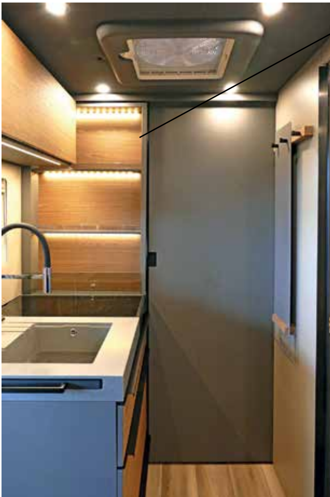
Kökslift helt uppkörd med tre hyllor synliga, position 3, rumsavdelare med stängd skjutdörr
