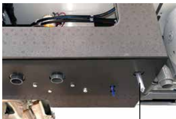
Slangstuts, säkerhets-/avtappningsventil under anslutningsfacket
