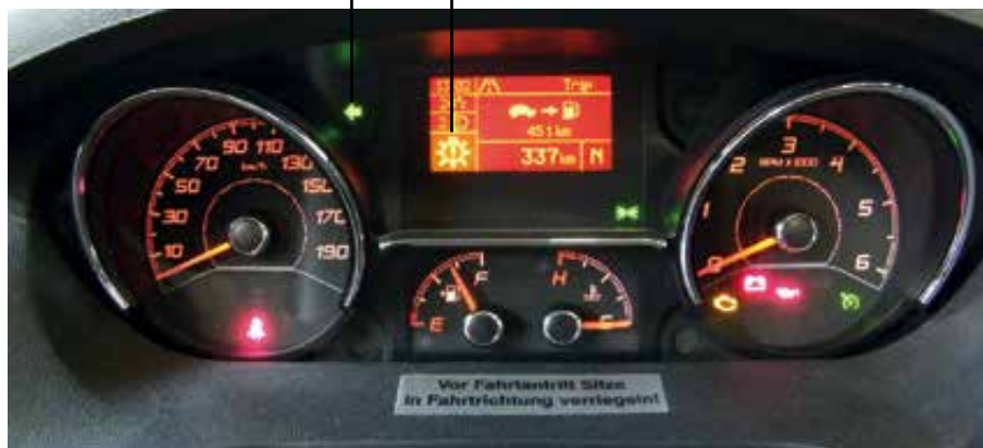
Meddelande vid defekt blinkers (exempel)
