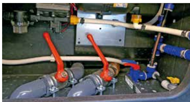
Tömningsventiler Tömning vatten- och avloppstank. Ventiler i anslutningsfacket (Bilden visar stängda ventiler)
