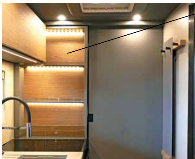
Kökslift komplett uppkörd med tre hyllfack
