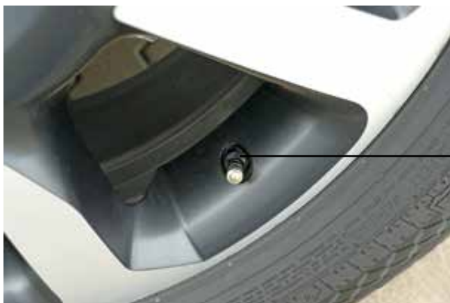
Metallventil på fram- och bakaxeln
