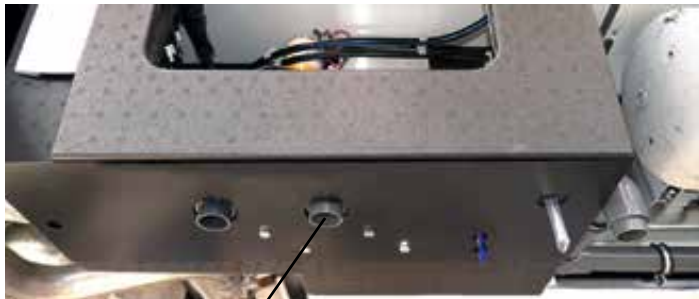
Utloupsrör under anslutningsfacket, vattentanken
