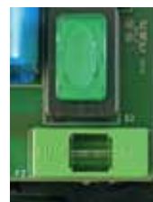
Protection electric currents input, F2-T 2A glass-tube fuse
